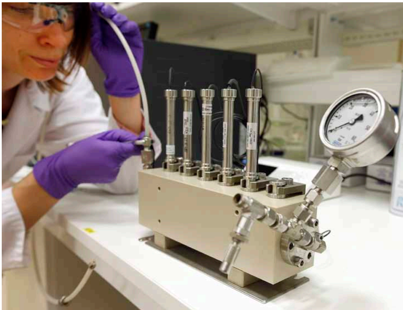
Kemiingenjör Yvonne Wallin monterar ihop den mätcell för kemiska analyser som utvecklats vid Äspölaboratoriet.
