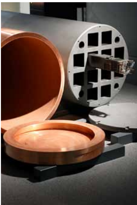
Det finska slutförvaret använder den svenska slutförvarsmetoden, KBS-3, som går ut på att kärnbränslet placeras i kopparkapslar med en insats av järn.
